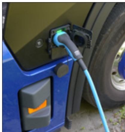
Na wyposażeniu znajduje się kabel do ładowania prądem przemiennym (400 V z sieci).
