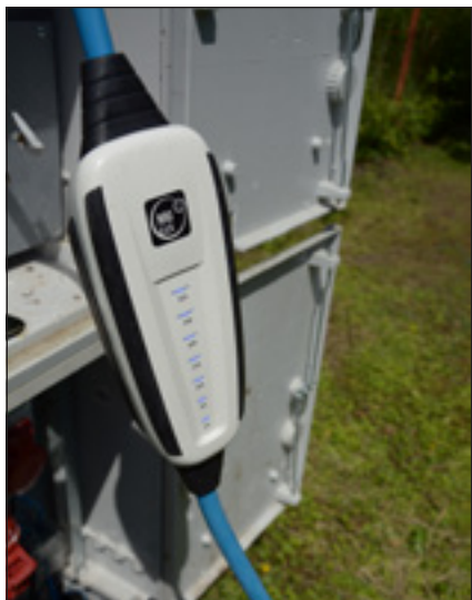
Na wyposażeniu znajduje się kabel do ładowania prądem przemiennym (400 V z sieci).
